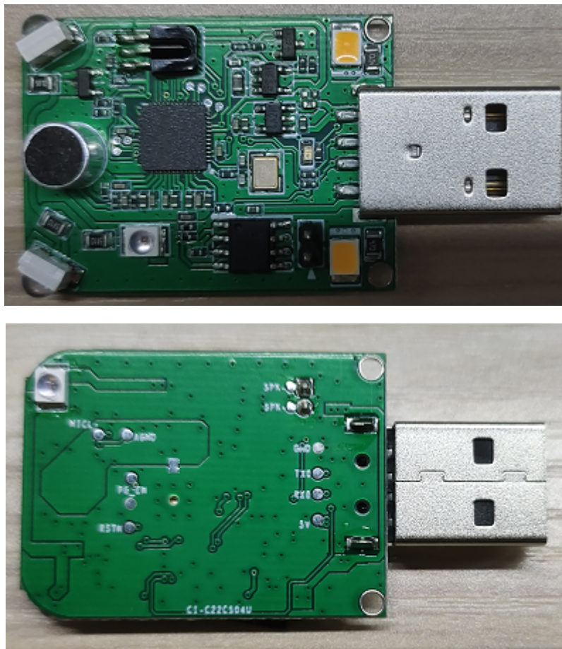
图2 模块实物和芯片对应位置图
