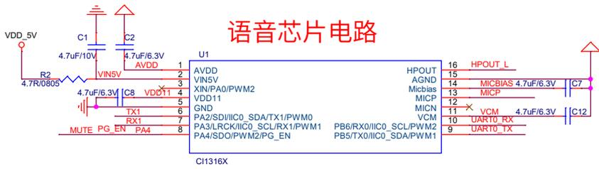
芯片8脚在开机过程中为升级使能脚，芯片内部有上拉，默认为升级模式，外部接下拉电阻开机跳过升级模式直接进入功能模式
