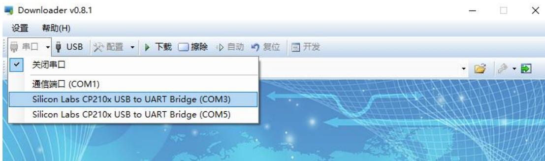
点击“下载”按钮，Xlink 的另一端接样机的 USB、SD 或者串口，上电程序自动下载到样机。
