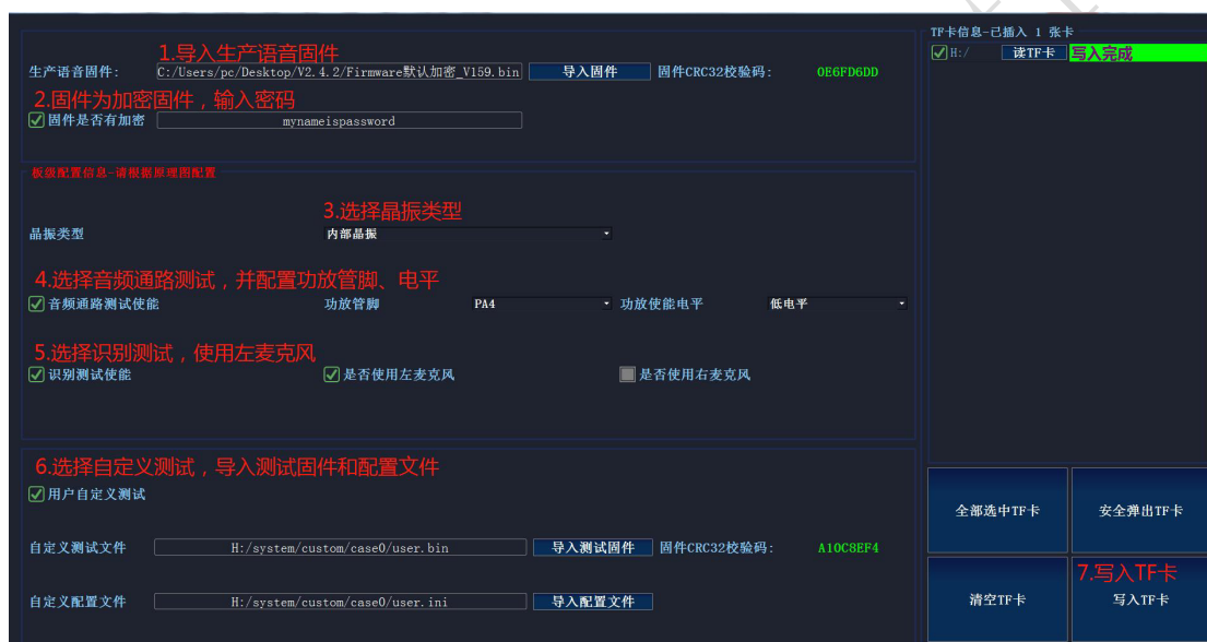
图 3-5 内部晶振 TF 卡配置
