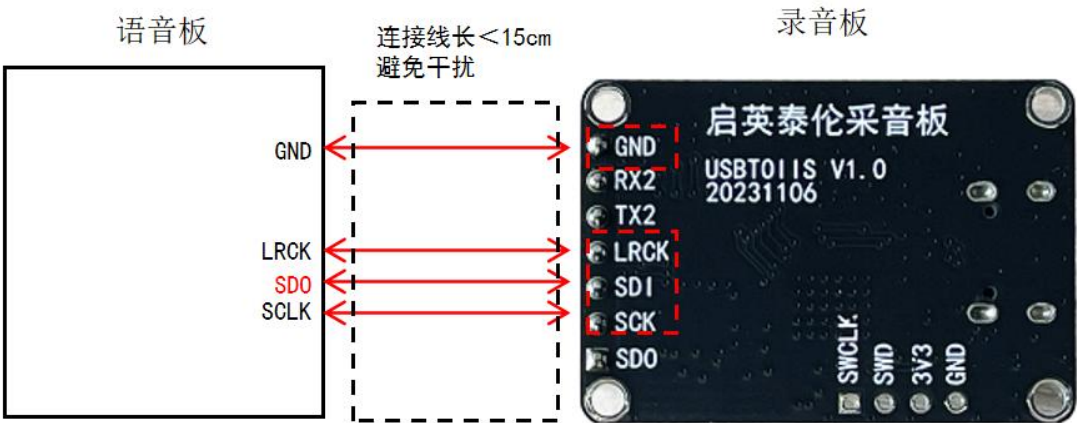
语音板与采样板连接框图
